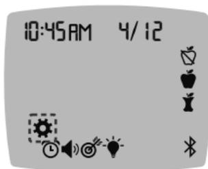
6. Para salir del menú **Configuración** y volver a la pantalla **Inicio**, pulse el botón ▲ o ▼ hasta que el símbolo **Configuración** ⚙️ esté parpadeando.
